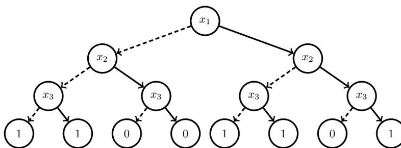
FIGURE 7.1 – Arbre de décision de l'expression booléenne  $(x_1 \vee \neg x_2) \wedge (\neg x_2 \vee x_3)$ . Une arête tiretée (resp. pleine) sortant d'un sommet  $x_i$  indique la décision où la variable  $x_i$  prend la valeur *faux* (resp. *vrai*). Les sommets 0 et 1 correspondent respectivement aux valeurs booléennes *faux* et *vrai*.
