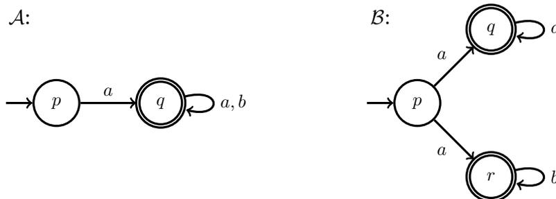
FIGURE 3.1 – Exemples d'automates de Büchi. L'automate  $\mathcal{A}$  accepte le langage  $a(a + b)^\omega$  et l'automate  $\mathcal{B}$  accepte le langage  $a(a^\omega + b^\omega)$ .
