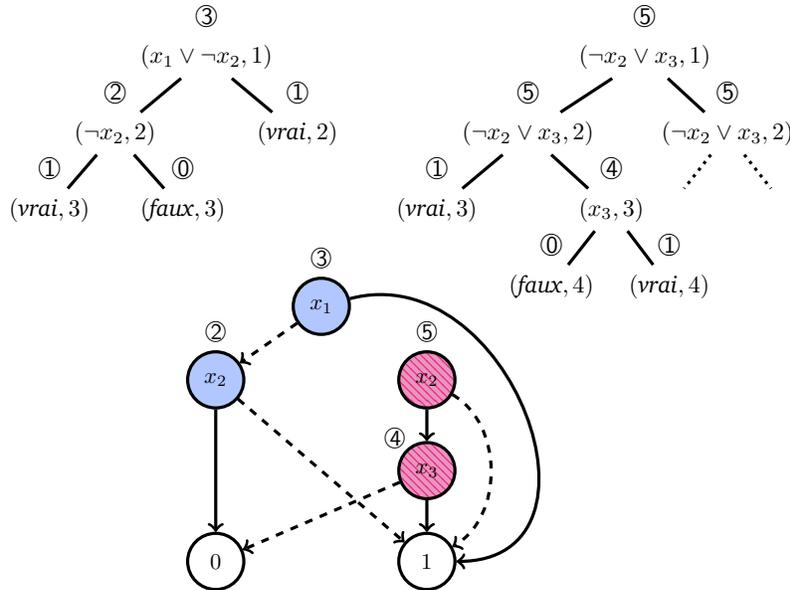
FIGURE 7.4 – *Haut gauche*: arbre d’appel de  $\text{build}(x_1 \vee \neg x_2)$ ; *haut droite*: arbre d’appel de  $\text{build}(\neg x_2 \vee x_3)$ ; où  $x_1 < x_2 < x_3$ , et chaque nombre encadré indique la valeur retournée par l’appel. *Bas*: BDD résultant des deux appels.
