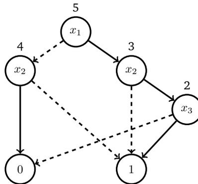
FIGURE 7.3 – Exemple d'un BDD sur trois variables  $x_1 < x_2 < x_3$ .
